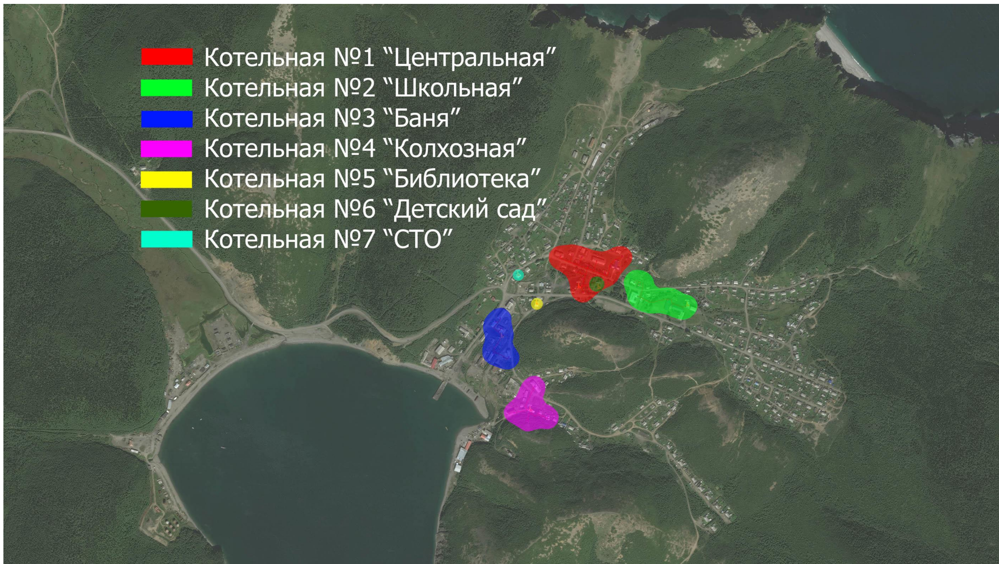
Рис. 2.1.1 – Зона действия системы теплоснабжения Муниципального образования «Село Аян»
