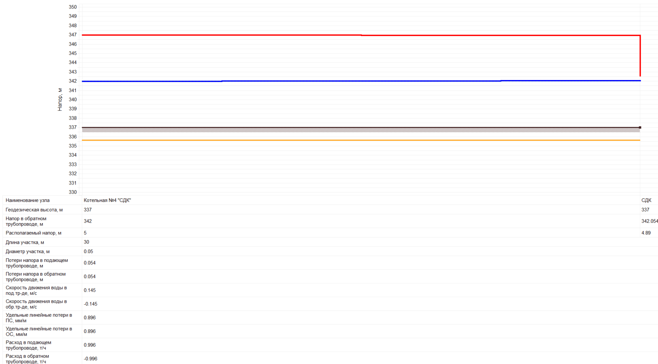
Рис. 1.6 – Пьезометрический график от котельной №4 «СДК» до СДК.
